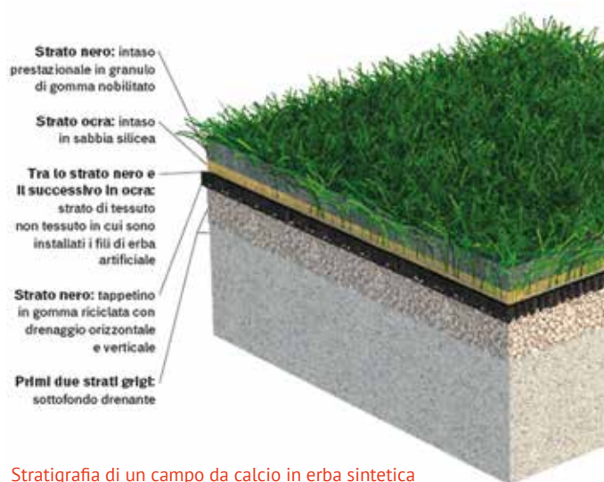
Stratigrafia di un campo da calcio in erba sintetica
